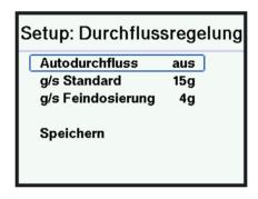
Die Durchflussmenge kann separat für den Abfüllvorgang vor und nach der Feindosierung eingestellt werden.
