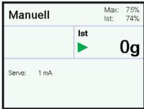
Im Handbetrieb wird der Öffnungswinkel des Servo direkt über den Drehregler bestimmt. Der eingestellte und an den Servo übergebene Öffnungswert wird in der oberen Zeile angezeigt.
