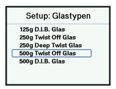
Die Füllmenge entspricht dabei der angegebenen Füllmenge auf dem Glas (z.B. 250g, 500g). Eine Kulanzmenge, um die Füllmenge nicht zu unterschreiten, wird im Punkt "Automatik" eingestellt.
