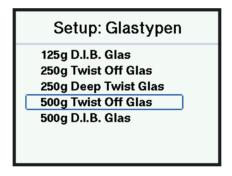
Über den Drehregler wird das zu verstellende Glas ausgewählt. Ein Druck auf den Drehregler-Taster schaltet zwischen Gewicht und Glastyp weiter. Wenn der Glastyp gewählt wurde, wird das Menu verlassen.
