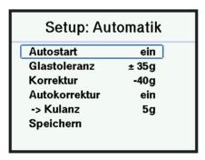
**Autostart** aktiviert die automatische Abfüllung, wenn ein aufgestelltes Glas erkannt wird. Ein Glas wird erkannt, wenn das Gewicht innerhalb der eingestellten **Glastoleranz** zur definierten Tara liegt.
