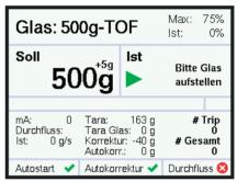
Wenn kein Füllvorgang aktiv ist (der Hahn also geschlossen ist), kann über den Auswahl-Taster direkt der Korrekturwert, der Glastyp und der Feindosierwinkel zur Verstellung angewählt werden.
