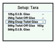
Zur Einstellung wird der zu ändernde Glastyp ausgewählt, ein leeres Glas aufgestellt, und über den Drehregler-Taster das Gewicht erfasst. Danach wird das Menu automatisch verlassen.
