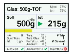
Ein teilgefülltes Glas wird nicht befüllt. Durch erneutes Drücken der Start-Taste wird die Befüllung erzwungen.
